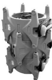
*Apilar (para guardar):* Las turbosecadoras Ace encajan para que resulte más fácil apilarlas, guardarlas y transportarlas. Coloque las unidades rejilla con rejilla. Gírelas hasta que las patas no estén alineadas.
